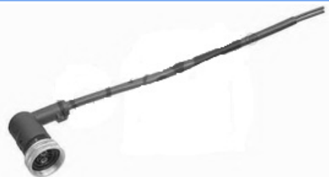
09024VLT -:кабель переходник с M24x1, угл. [8946004502] L=3000 mm роз. 3 конт. 2пров.
