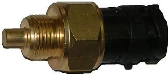
01071VLT -:датчик блокировки дифференциала (унив. байонет 2конт./M18x1,5)
