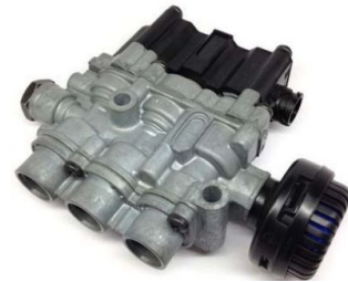
05152VLT -:блок ECAS [4729000550] DAF/MAN/RVI/IVECO/SCANIA
